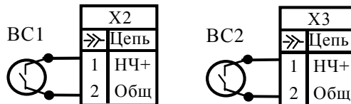
Рисунок 5.5 – Подключение ВС к моделям 01-04
